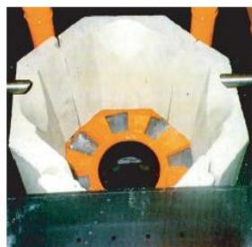
回転火格子と光学的燃焼室センサーを備えた燃焼室
